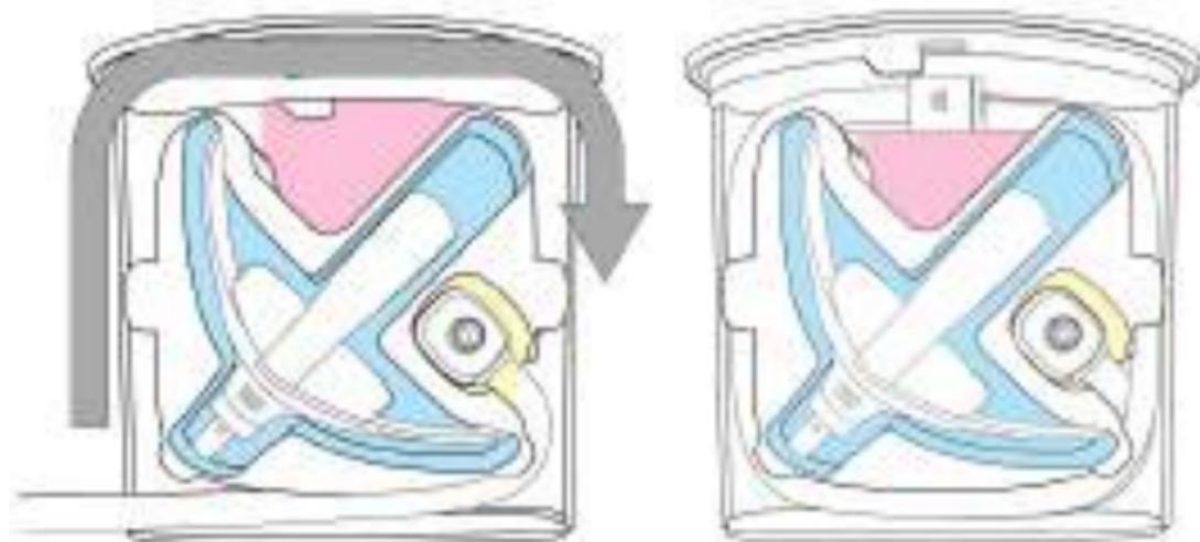
將儲液槽接口放置在 C 處並將管路組依照順時針方向繞放。最後將管路組尾端的接口放置於 B 處
