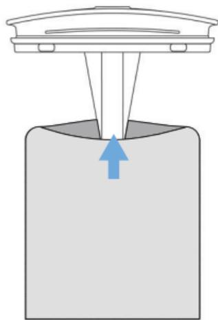
擠壓集液袋側邊讓集液袋打開後，將集液袋套在儲液槽的支撐架上。
