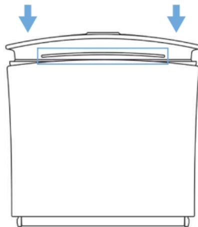
儲液槽上蓋安裝於儲液槽下蓋時，須注意定位線需位在儲液槽下蓋內。
