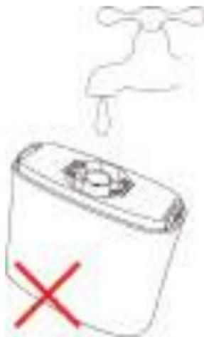
**⚠ 注意：**請勿觸碰或刷洗在儲液槽下蓋底部的防水透氣膜。當儲液槽下蓋被唾液接觸過或弄濕時，請將儲液槽下蓋自然風乾。
